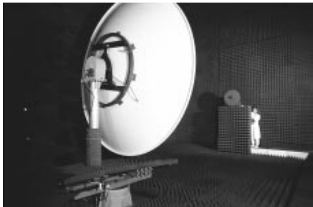
Fig. 9.8 Cámara anecoica de la ETSITB
